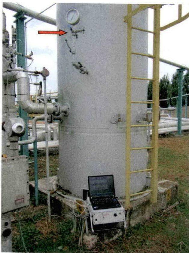
Foto 1 – Punto di campionamento e gascromatografo portatile modello µGC 3000 della Agilent
