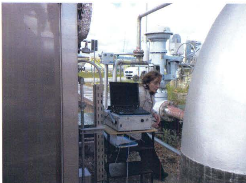
Foto 3 – Gascromatografo portatile µGC 3000 Agilent
