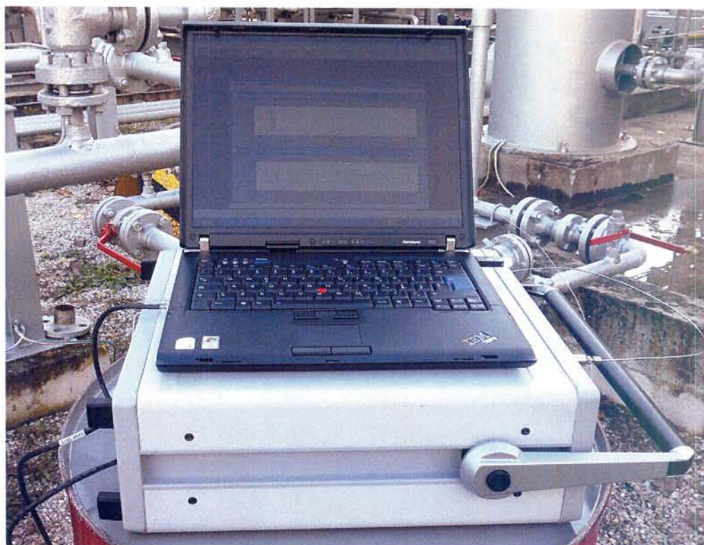
Foto 2 - gascromatografo portatile modello \mu GC 3000 della Agilent
