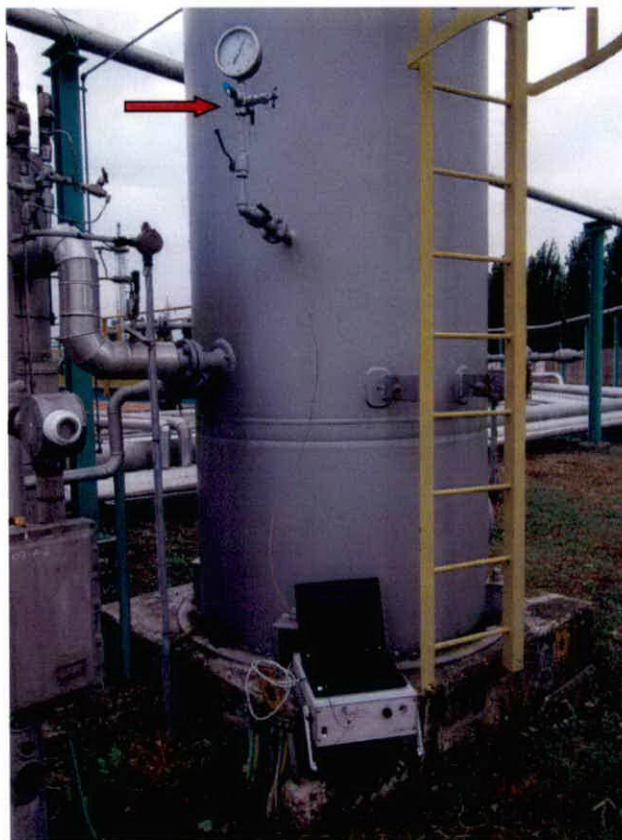
Foto 1 – Punto di campionamento e gascromatografo portatile modello \mu GC 3000 della Agilent
